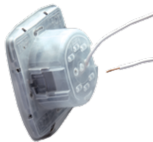
Introduceți cablurile în orificiile aferente aflate pe partea din spate a membranei de protecție și conectați-le la dispozitiv
